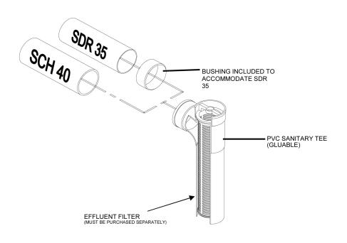
**OUTLET BAFFLE DETAIL**
